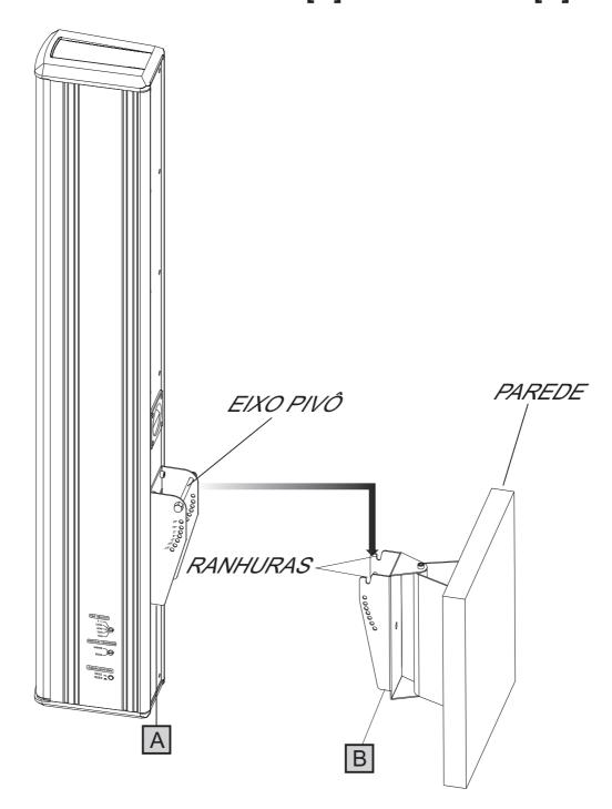
**5**- Com a caixa seguramente apoiada sobre o suporte [B] através do eixo pivo, rotacione o conjunto (caixa-acústica e suporte [A] ) até encontrar o ângulo necessário.
