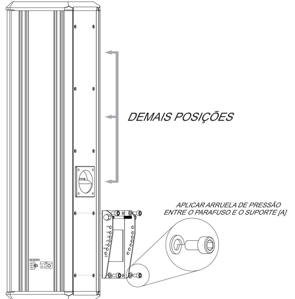
4- Uma vez fixado o suporte [A] na caixa, posicione seu eixo pivô dentro das ranhuras do suporte [B], o qual deverá estar fixado na parede.
