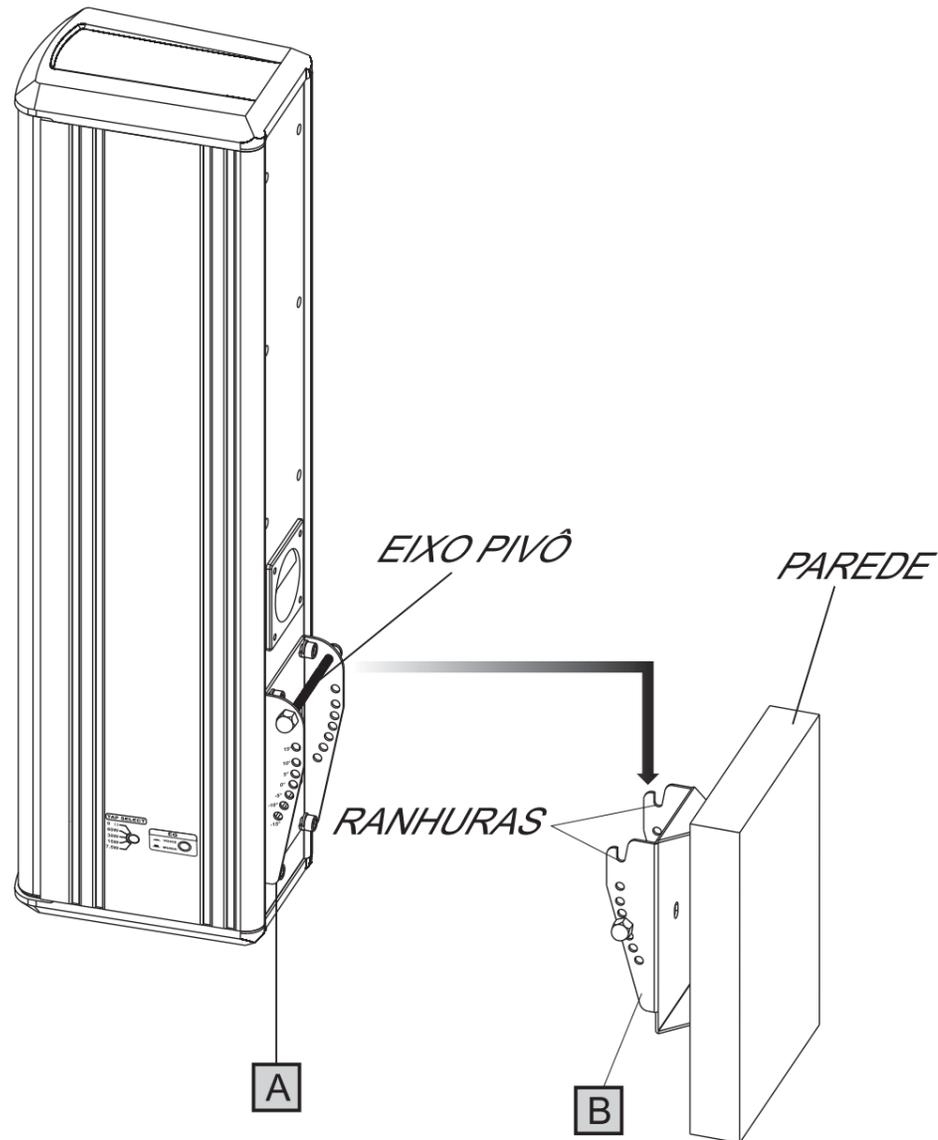
5- Com a caixa seguramente apoiada sobre o suporte [B] através do eixo pivo, rotacione o conjunto (caixa-acústica e suporte [A]) até encontrar o ângulo necessário.
